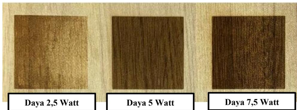
Gambar 3. Hasil visual setelah dilakukan pengukiran laser CO<sub>2</sub> pada kayu cempaka dengan berbagai daya laser.
